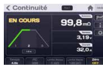
Test en cours
