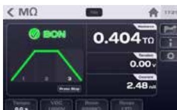
Test Bon terminé
